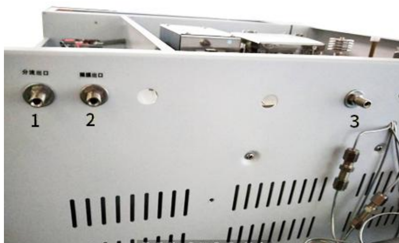
图 9（图中 1 为分流出口 2 为隔膜出口 3 为参比出口）
