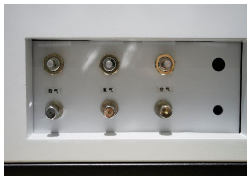
图 5 (1 为载气控制开关 2 为氢气控制开关 3 为空气
